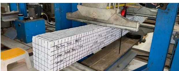
Gambar 9. Posisi memanjang balok pada mesin uji kuat lentur
