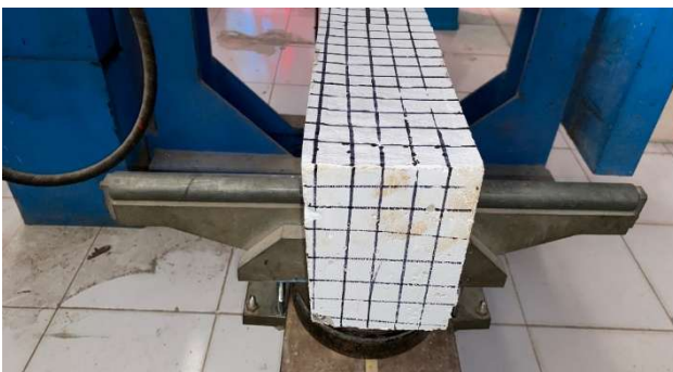
Gambar 8. Posisi melintang balok pada mesin uji kuat lentur
