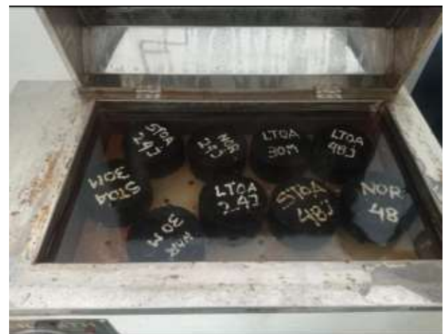
Gambar 1. Proses pengujian dengan menggunakan alat Water Bath pada sampel Normal, sampel STOA dan sampel LTOA pada lama variasi rendaman.
