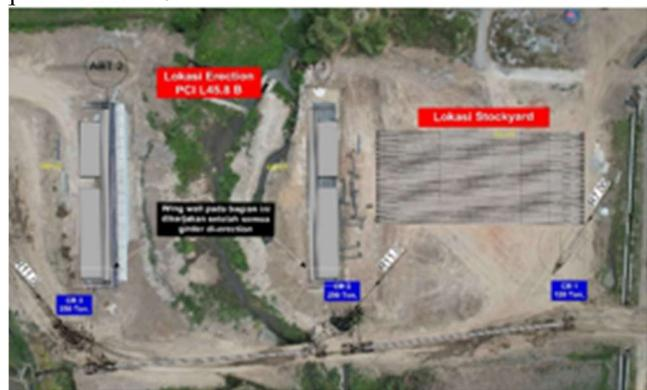
**Gambar 6.** *Erection plan* menggunakan *Gantry Launcher*
