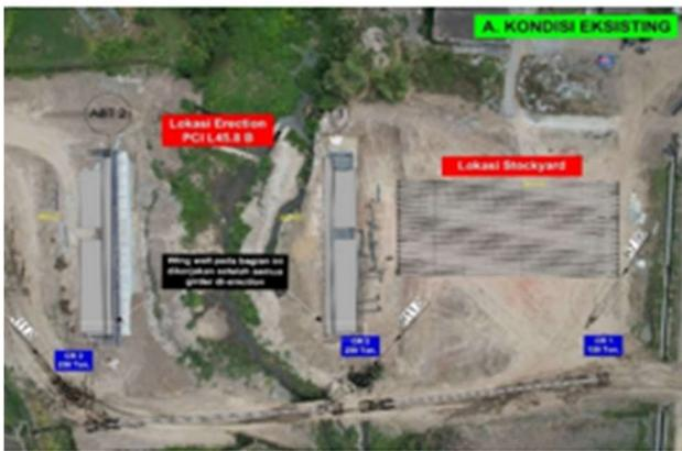
**Gambar 5.** Erection plan menggunakan Crawler Crane
