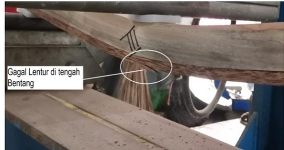
**Gambar 12.** Keruntuhan lentur mode II balok laminasi
